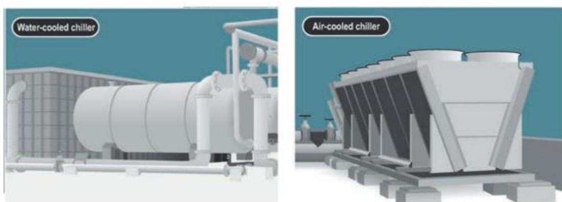
Figura 68. Chiller de água gelada e de ar. Fonte: IEA (2018).
