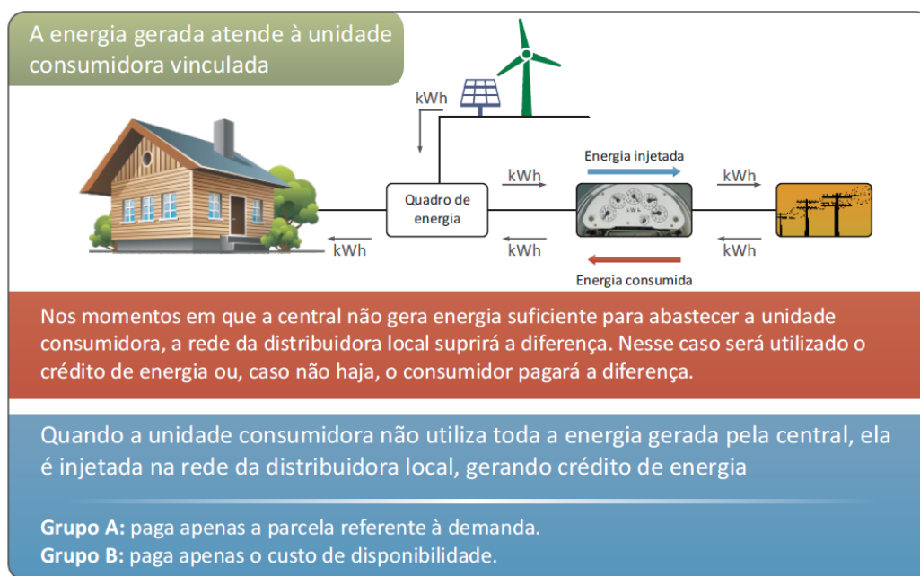
Figura 22. Sistema de compensação de energia elétrica. Fonte: ANEEL – Cadernos temáticos Micro e Minigeração distribuída (2016).
